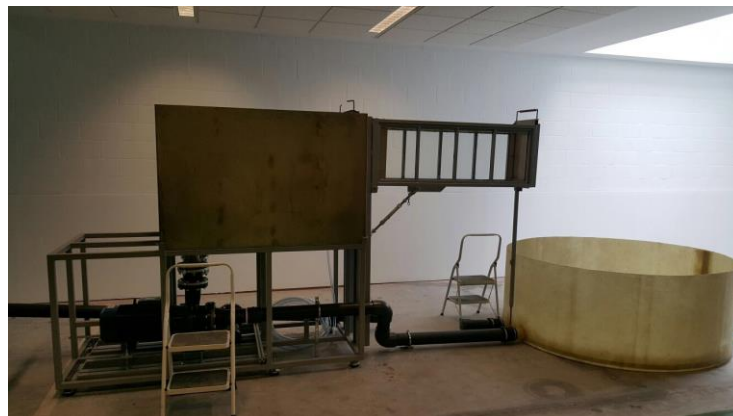
Figura 1(b): Túnel de agua instalado
