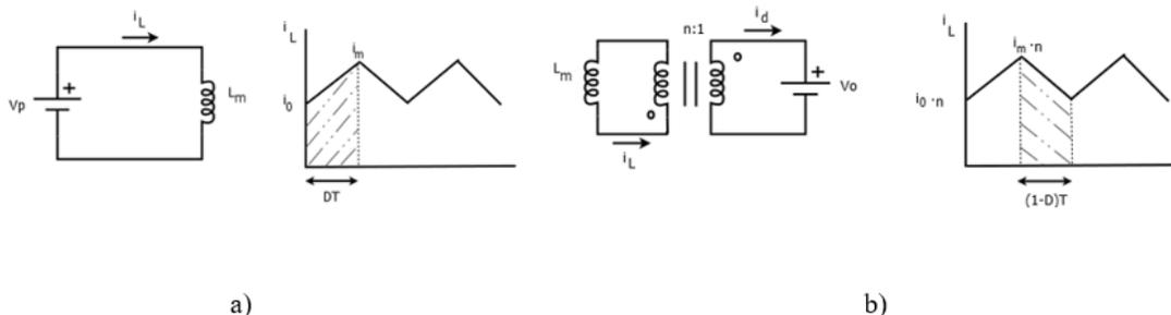
Fig.5. a) Switch ON interval b) Switch OFF interval
